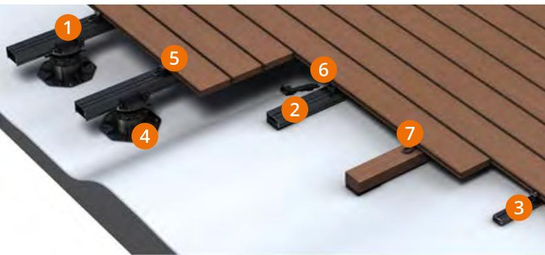
Befestigung von Terrassendielen auf einer Aluminium-Unterkonstruktion:
